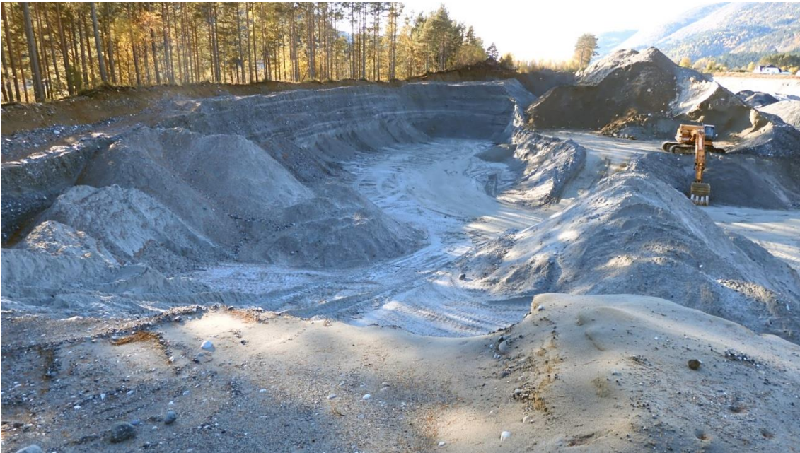
Figur 7. Skråningen til venstre som viser en horisontal, sedimentær lagning ligger på sørsiden av sandtaket i dets østligste del, nærmest Hornindalsvannet.
