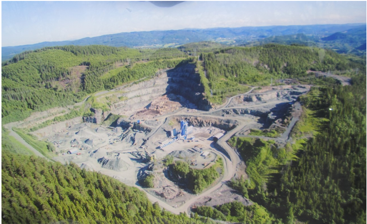
Luftfoto av Lia Pukkverk sett mot sørøst. Palleveggen til høyre på fotoet består av et grønnsteins-konglomerat som på det geologiske Trondheimskartet 1: 50 000 danner grensen mellom Størenggruppen i øst og Bymarkgruppen i vest. Fotoet eies av Lia Pukkverk.
